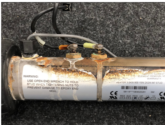
Värmare som körts utan vatten!
